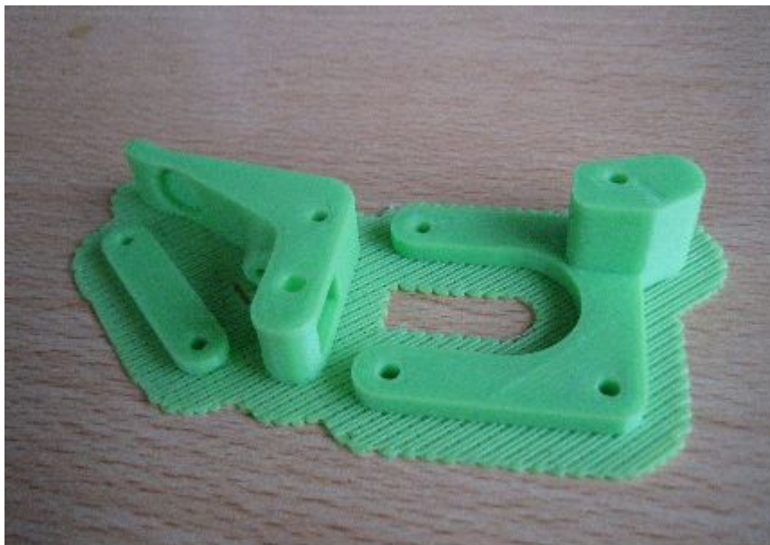
Figura 11 - Camada de raft para aumentar a área de aderência - Fonte: wiki.cac.washington.edu
